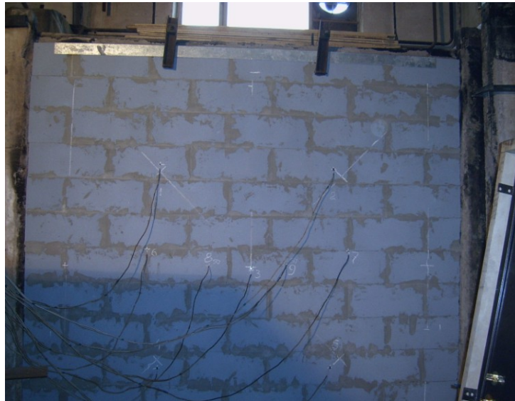
Рис. 1. Определение огнестойкости фрагмента толщиной 100 мм из газозолобетона марки D500 ООО «ПСО «Теплит»
