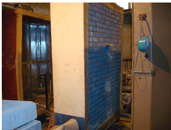
Рис. 3. Испытываемый в лабораторных условиях стеновой фрагмент
